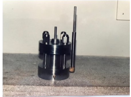
Célula Edométrica de Sucção Controlada
