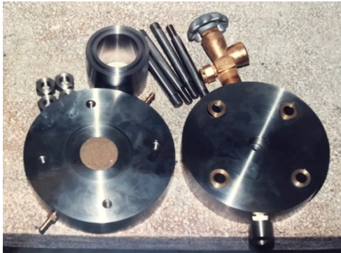
Célula Edométrica de Sucção Controlada
