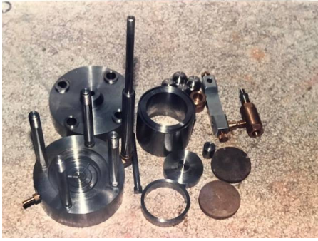
Célula Edométrica de Sucção Controlada
